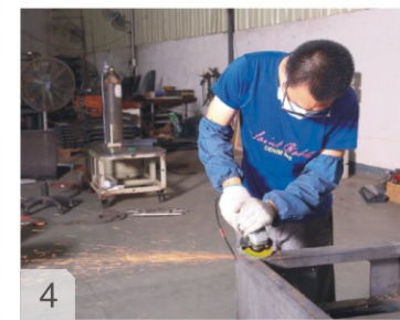
4 表面打磨抛光处理 Surface polishing
